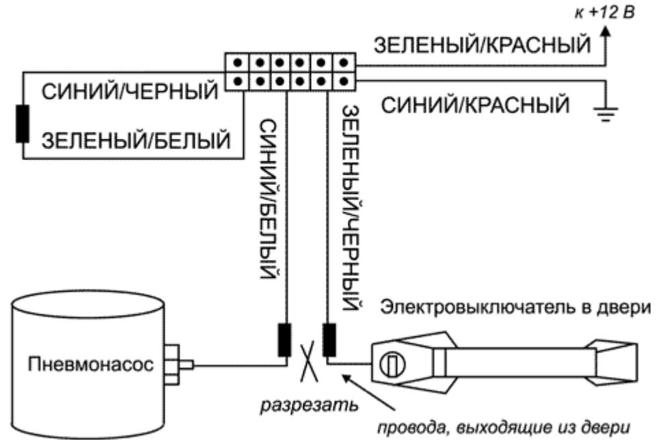
Схема 5. Однопроводный тип цепи дверных замков с отрицательной полярностью (некоторые автомобили марки Ниссан, Mazda и др.)
