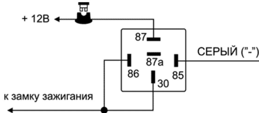
2. СЕРЫЙ провод может быть также запрограммирован как "отрицательный выход при включенном режиме охраны" (программируемая функция № 19). В этом случае провод уже более не управляется при нажатии кнопок передатчика; вместо этого этот провод будет автоматически замыкаться на "массу" при включенном режиме охраны и может использоваться для управления дополнительным нормально замкнутым реле блокировки стартера.
