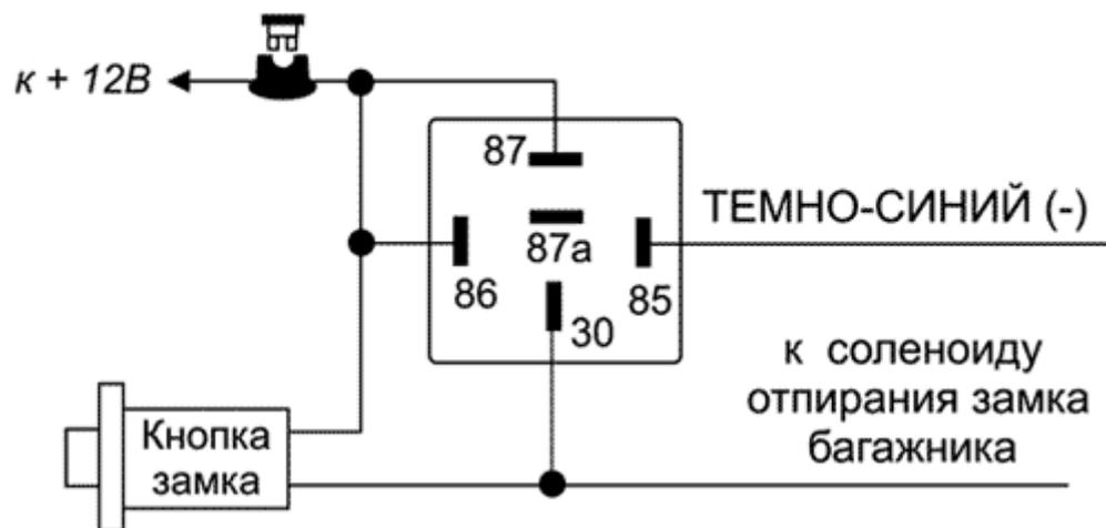
2. Выход канала 2 системы (ТЕМНО-СИНИЙ провод) может также использоваться для управления различными иными дополнительными устройствами. Режим работы выхода канала 2 системы в этом случае может быть запрограммирован при установке системы (программируемая функция № 17) как
