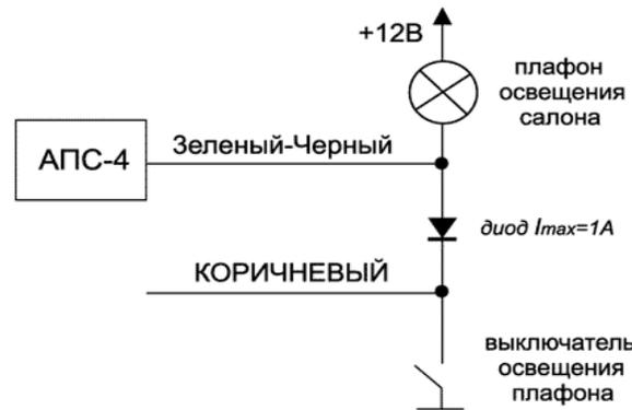
2. Рекомендуемая схема подключения КОРИЧНЕВОГО провода системы ("отрицательный триггер двери") к проводке автомобилей ВАЗ семейств 2110 и 2115, оснащенных иммобилайзерами АПС-4:
