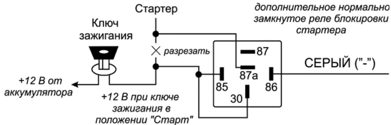
**Подсоединение:** Подсоедините СЕРЫЙ провод системы к клемме № 86 дополнительного реле. Подсоедините клемму № 85 реле к проводу от замка зажигания, на который поступает напряжение +12В, когда ключ зажигания находится в положении "ЗАПУСК" (CRANK), и присутствует напряжение 0В, когда ключ зажигания находится в любом ином положении.
