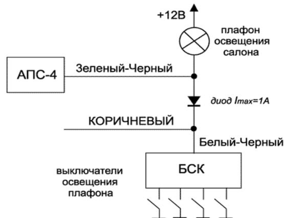
3. Рекомендуемая схема подключения ТЕМНО-ЗЕЛЕННОГО провода системы ("отрицательный триггер капота/багажника") к подкапотной лампе автомобилей ВАЗ семейств 2109, 2115, 2123 или лампе освещения багажника автомобилей ВАЗ семейства 2115:
