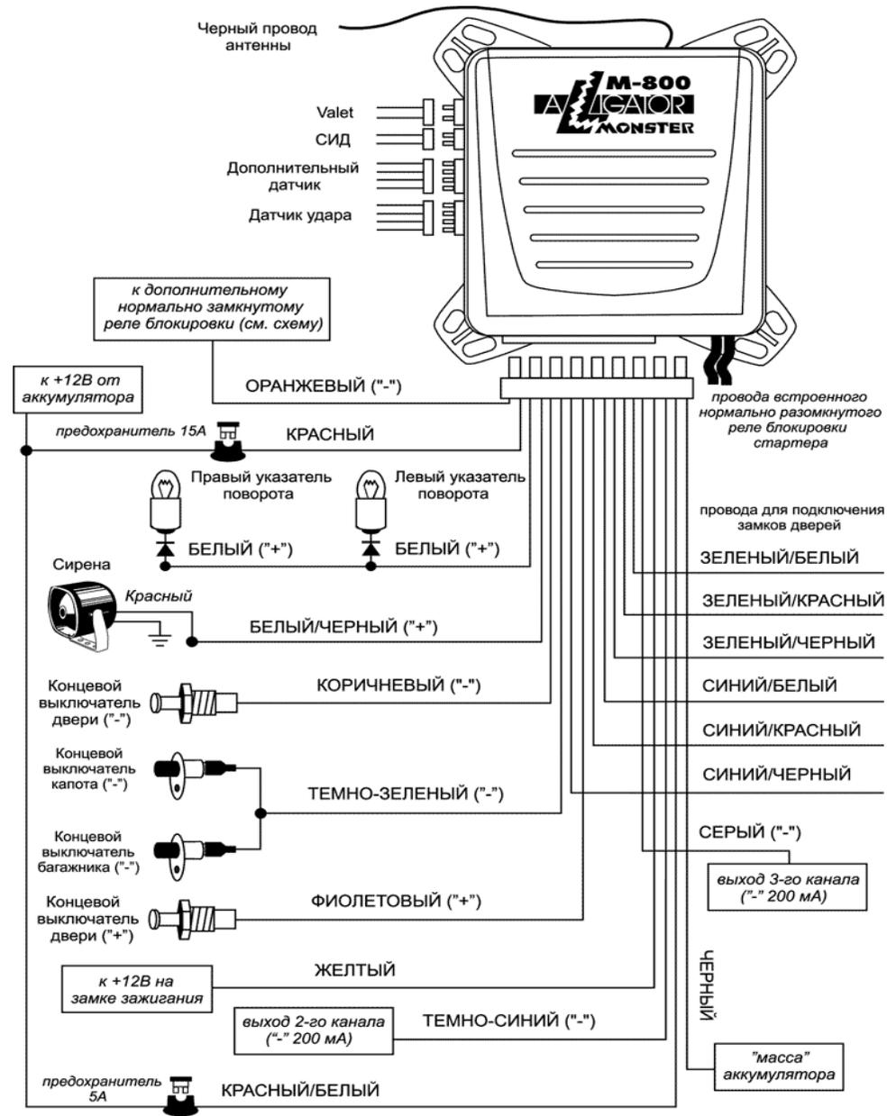
Схема 1. 3-проводная система центрального замка, управляемая сигналом отрицательной полярности (большинство автомобилей японского производства)
