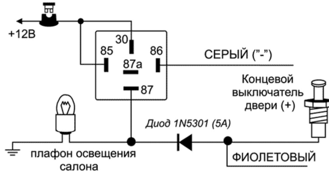
**ВНИМАНИЕ:** Обязательно используйте диод для изолирования цепи управления внутрисалонным освещением от цепи триггера двери. В противном случае не сможет правильно работать функция пассивной постановки на охрану и функция автоматической повторной постановки системы в режим охраны.
