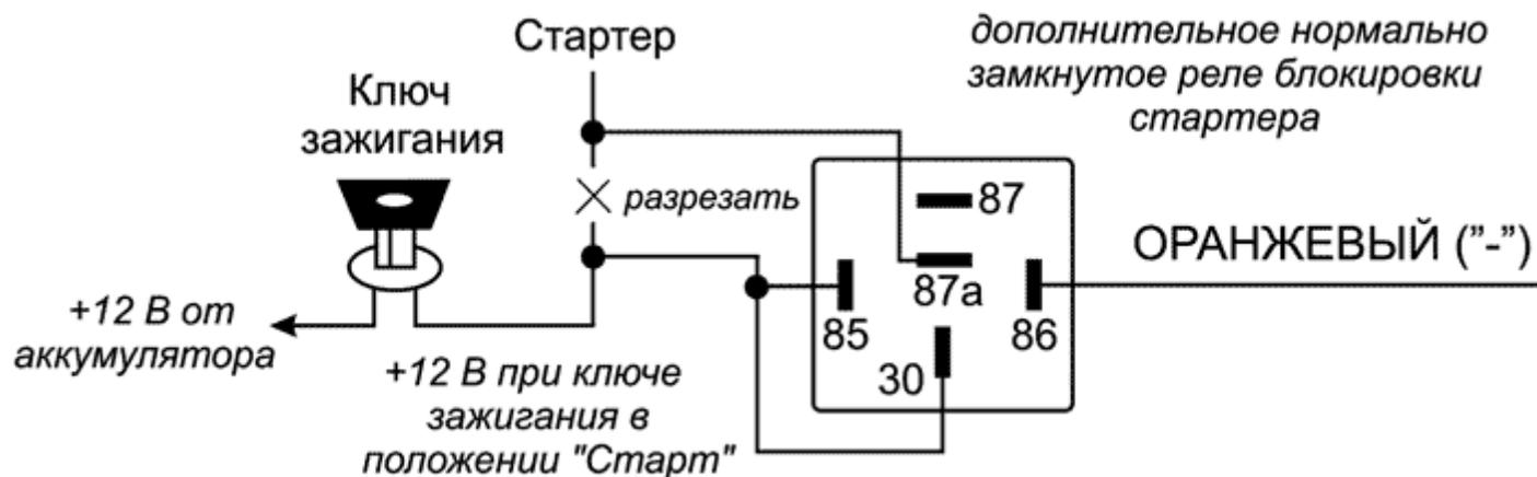
**Подсоединение:** Подсоедините ОРАНЖЕВЫЙ провод к контакту № 86 дополнительного реле блокировки стартера. Подсоедините контакт № 85 реле к проводу от замка зажигания, на который поступает напряжение +12В, когда ключ зажигания находится в положении "ЗАПУСК" (CRANK), и присутствует напряжение 0В, когда ключ зажигания находится в любом ином положении.
