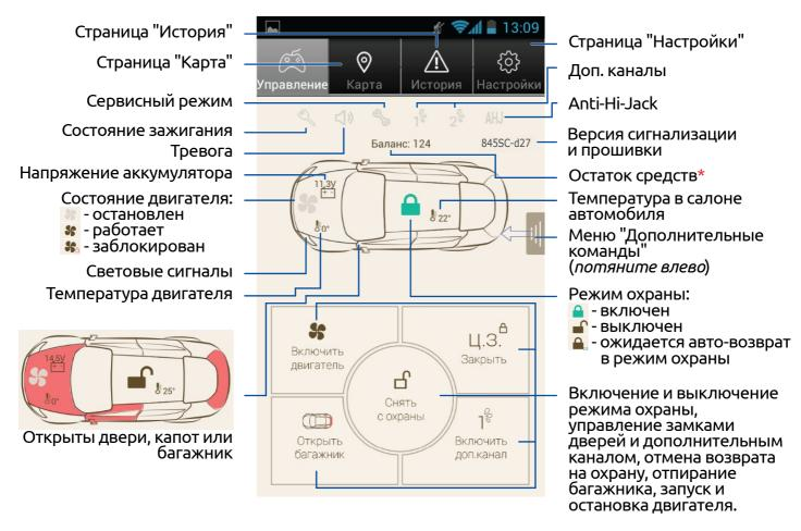
Во избежание ненамеренного отпирания дверей автомобиля при случайном нажатии кнопки "Снять с охраны" - при выключении режима охраны двери остаются закрытыми. Для их отпирания нажмите кнопку "Ц.З. ОТКРЫТЬ".
