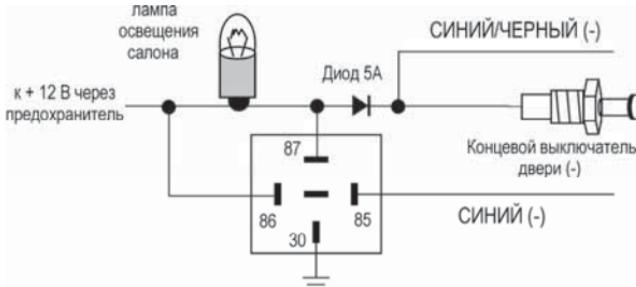
При положительных концевых выключателях дверей:
