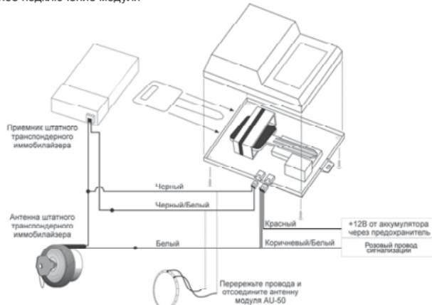
Подключение данного провода также может быть необходимо в том случае, если в автомобиле более двух цепей зажигания.
