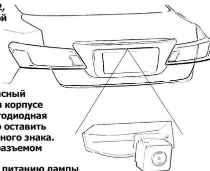
При включенном питании монитора, включите заднюю передачу, на экране должно появиться изображение пространства позади автомобиля.
