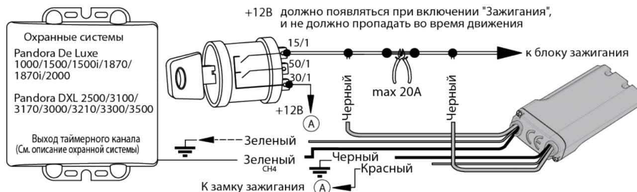
В режиме программирования "Зеленый" провод соединить с "Массой" таймерного канала, после успешного программирования "Зеленый" провод отсоединить и изолировать
