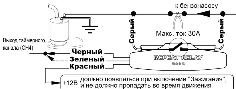
Преимущества данного способа блокировки заключаются в том, что даже при обнаружении базового блока системы, скрытое реле невозможно включить простой подачей питания или замыканием провода на массу. Реле имеет небольшие габаритные размеры и может быть замаскировано в жгуте электропроводки.
