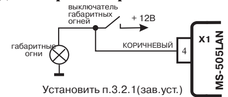
Рис. 17. Подключение сервисного входа для контроля габаритных огней
