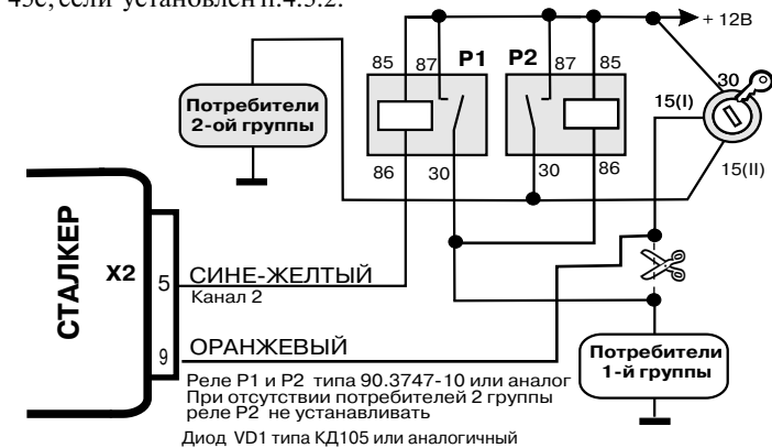
Рис. 15. Схема подачи зажигания при постановке на охрану с заведённым двигателем без ключа в замке зажигания
