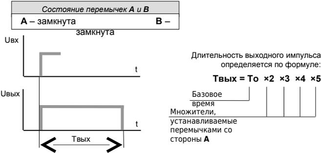
**Пример** Пусть имеется таймер Т6.0 с  $T_0 = 1$  сек. Для получения выходного импульса с длительностью 15 секунд необходимо удалить переключки  $\times 3$  и  $\times 5$  со стороны А ( $T_{\text{вых}} = 1 \text{ сек} \times 3 \times 5 = 15$  секунд)
